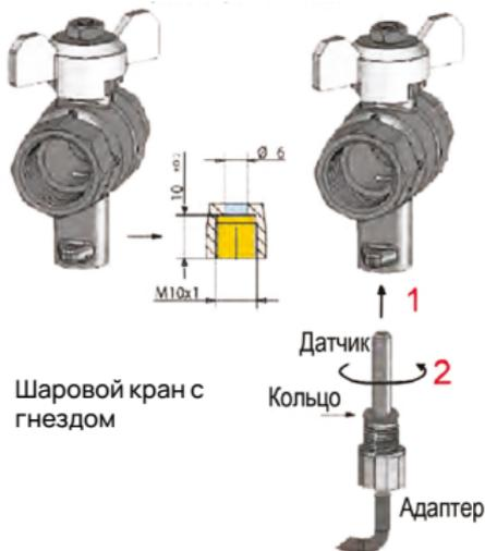
После монтажа датчик должен перекрывать как минимум две трети диаметра трубопровода. Установленные датчики рекомендуется пломбировать.
